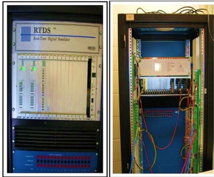
شکل ۲. نمای روبرو و عقب یک شبیه‌ساز دیجیتال زمان-حقیقی
