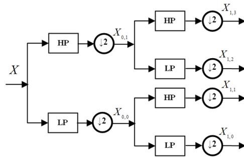
شکل ۴: تجزیه‌ی ویولت بسته‌ای سیگنال در ۲ سطح
